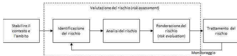
Figura 4.0.1: Le fasi della gestione del rischio
